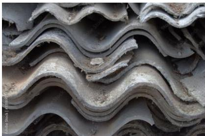
**Asbestzementplatten** wurden häufig für Dächer- und Fassadenverkleidungen verwendet. Beim Zerschlagen oder Bearbeiten dieser Platten werden Asbestfasern freigesetzt, die aufgrund ihrer Lungengängigkeit (feinste Fasern, die der Länge nach zerbrechen) ein hohes Krebsrisiko darstellen.
