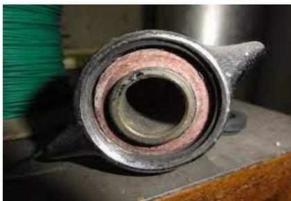
**Asbesthaltige Dichtungen** finden sich oft in Flanschen älterer Heizungs- oder anderen raumtechnischen Anlagen.
